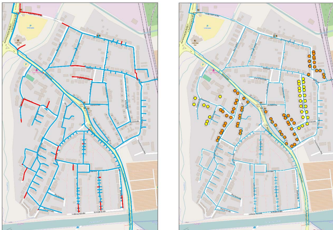
Abbildung 2: Trinkwassernetzabschnitte in Lünen mit Stagnationswahrscheinlichkeit (rote Abschnitte) vor (linke Karte) und nach zusätzlicher Vermaschung und Querschnittsanpassung (rechte Karte)
